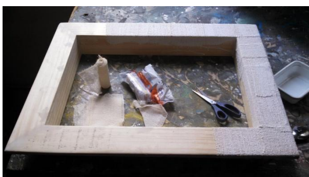
Figura a3: Produção da forração do caixote de ar condicionado com atadura e cola branca. Fonte: Fotografia do autor.
