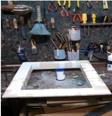
Figura a4: Produção da forração do caixote de ar condicionado com atadura e cola branca. Fonte: Fotografia do autor.
